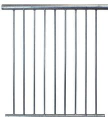
Die Geländerelemente können komplett im Interclamp System integriert werden. Mit dem Baukastensystem montieren Sie blitzschnell ein Sicherheitsgeländer. Oberes und unteres Rohr aus 1.5" (48 mm), senkrechte Rohre Ø 12 mm, Abstand zwischen senkrechten Stäben 8 cm.
